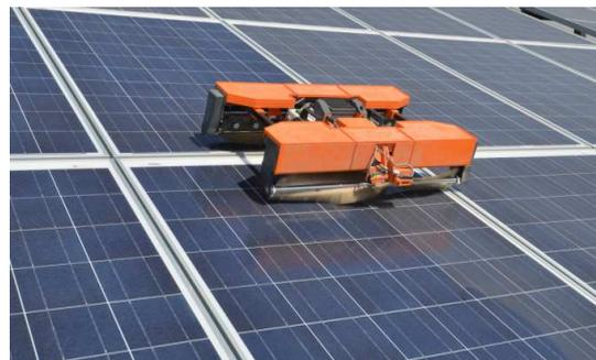
【高松—2013年3月26日】—香川大学発ベンチャー企業：株式会社未来機械（代表取締役社長：三宅徹、香川県高松市）は、国立大学法人香川大学（学長：長尾省吾、香川県高松市）工学部知能機械システム工学科、石原秀則 准教授の指導・協力を受けて、ソーラーパネルの上を自動走行しながら、水を使わず清掃できる、世界で類を見ないソーラーパネル清掃ロボットを実現しましたのでお知らせします。
